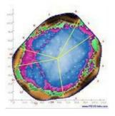
**Tomografia por impedância elétrica -** A árvore é submetida a uma pequena carga elétrica, dependendo da composição, da presença de danos e da umidade no tronco o campo elétrico terá uma variação de carga que permite avaliar eventual dano. Com esta técnica é possível a análise de palmeiras e ciprestes uma vez que estes indivíduos não podem ser analisados com tomografia sônica.
