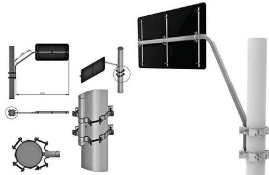
O suporte deverá ser totalmente galvanizado a fogo, interna e externamente, conforme NBR6323, 7399 e 7400.
