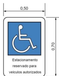
Figura 1 - Sinalização para vaga de veículo
