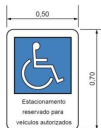
Figura 1 - Sinalização para vaga de veículo
