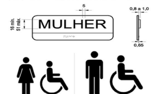
Figura 17 - Sinalização visual e tátil em sanitários acessíveis
