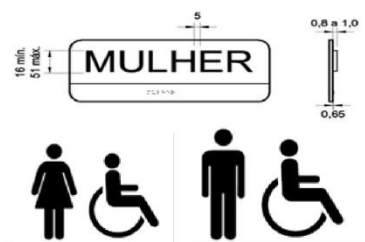
Figura 19 - Sinalização visual e tátil em sanitários acessíveis
