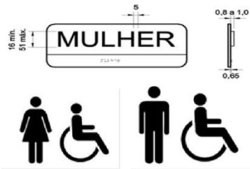
Figura 17 - Sinalização visual e tátil em sanitários acessíveis
