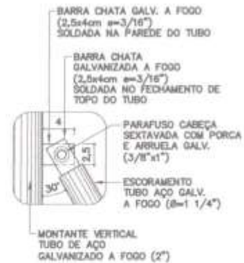
DET. FIXAÇÃO SUPERIOR DO ESCORAMENTO ESC. 1:5
