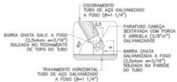
DET. FIXAÇÃO INFERIOR DO ESCORAMENTO ESC. 1:5
